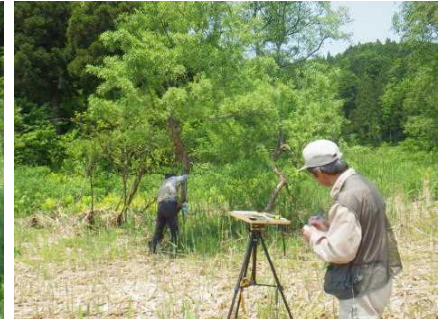
図28 ③レーザー距離計で樹木と測定器間の距離を測る。これに②を加えると樹高となる。
