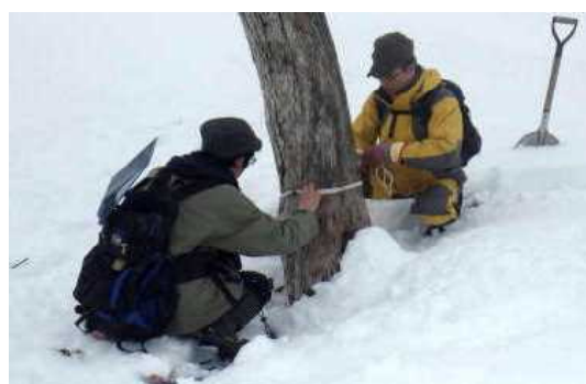
図8 雪面と同じ高さ目印のひもを巻く。 2016.02.20
