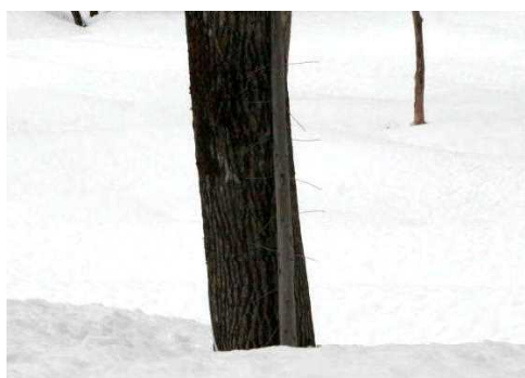
図7 アルミの針金の曲がり具合で、おおよその最高積雪深を読み取る。 2016.02.20
