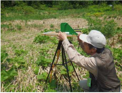
図26 ①タンジェントハイトゲージで仰角45度の地点を見付ける。
