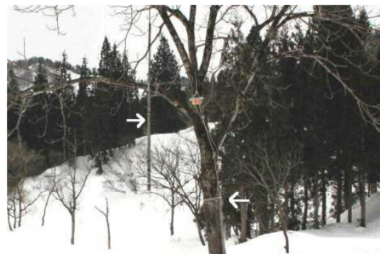
図6 最大積雪計(左上矢印)と今回計測した補助積雪計(右下矢印) 2016.02.20
