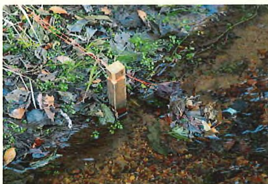
図230 調査水路AWC1の中に設置した 温度データロガー
